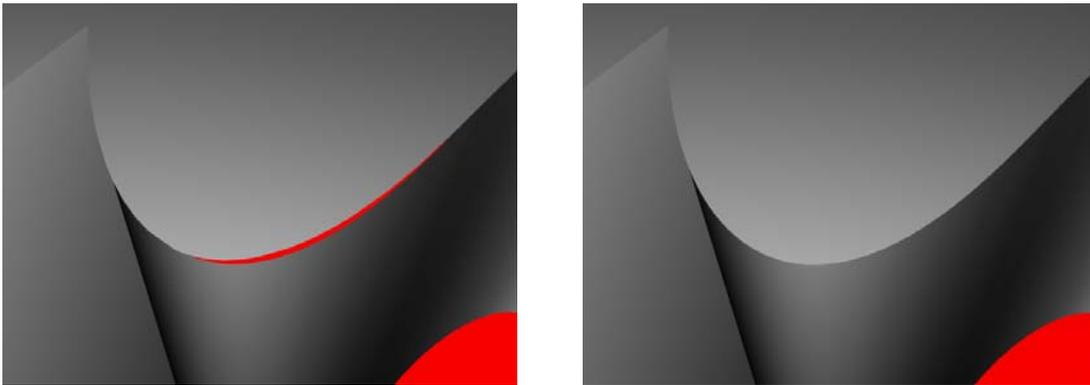
Fig. 10. Comparación de la calidad entre una superficie trimeada en Max (izquierda) y la misma superficie ya trimeada en Rhino. Se ha puesto un entorno rojo para apreciar mejor los fallos de cosido en el borde.
