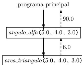
Las llamadas se producen de arriba a abajo y siempre desde la función de la que parte la flecha con trazo sólido. La primera flecha parte del «programa principal» (fuera de cualquier función). El valor devuelto por cada función aparece al lado de la correspondiente flecha de trazo discontinuo.
