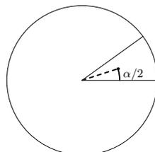
El punto tiene por coordenadas  $(0.5\text{radio} \cos(\alpha/2), 0.5\text{radio} \sin(\alpha/2))$ :
