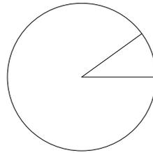
Hemos de dibujar dos líneas. La línea horizontal es muy sencilla: parte de  $(x, y)$  y llega a  $(x + \text{radio}, y)$ :
