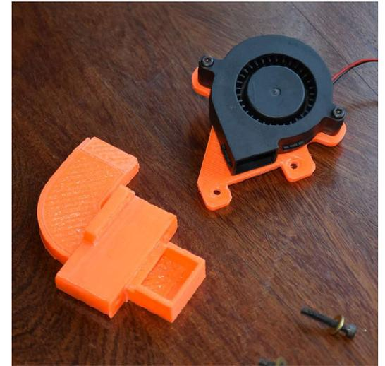
Otro accesorio que realice fue el FAN DE CAPA, de diseño bastante complejo para no limitar ningun movimiento y a la vez fijarlo sin modificar ni agregar nada de la cabezal original. Esta impreso en PLA, el diseño en Tinkercad.
