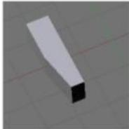
**PINZA DERECHA:** su único movimiento es la traslación a través de la base del eje de la pinza.
