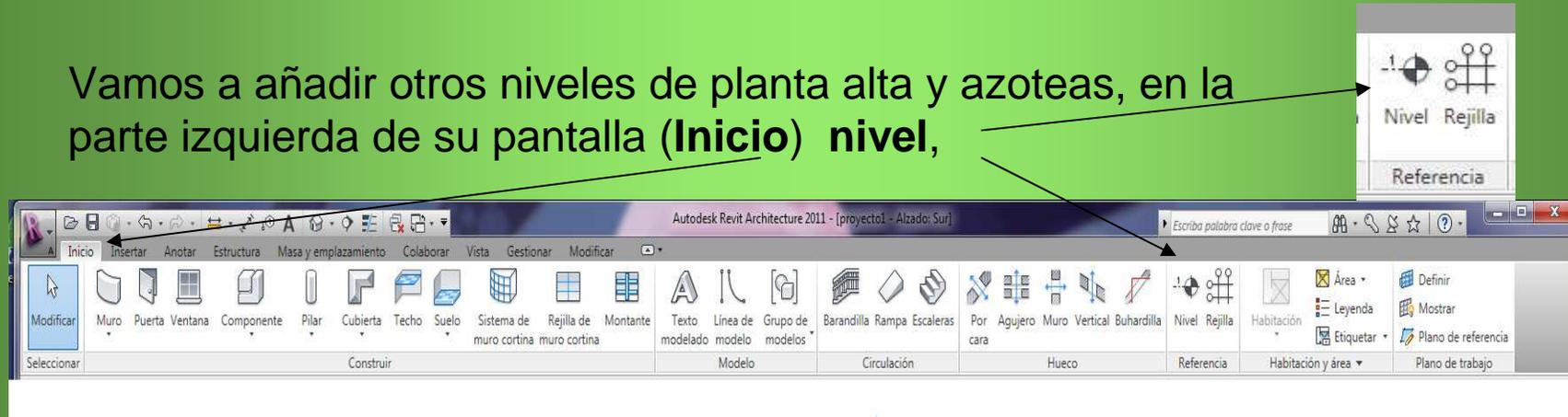
En el área de dibujo, acercar el cursor a la izquierda de la línea de Planta baja y aparece un cuadro (*punto final*) en la orilla de la línea, suben un poco el cursor y aparece una línea punteada que indica donde comenzará la línea visual de nuestro nuevo nivel y una cota, esta la suben hasta que indique 2.8, clic y mueve el cursor a la derecha hasta que aparece una línea punteada, clic, el nivel es 3.80
