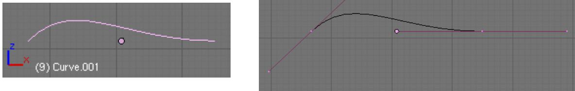
Bien, entra en modo edición y verás que por cada vértice que tiene pasa otra línea con 3 vértices, el del medio sirve para mover ese vértice de sitio y los otros dos para dar efecto a la curva y curvarla más o menos en un sentido u otro.
