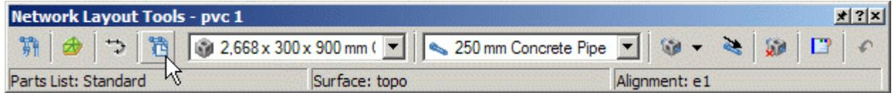
9 En la barra de herramientas Herramientas de composición de la red, seleccione las piezas deseadas (tuberías y estructuras) en la Lista de tuberías y la Lista de estructuras.
