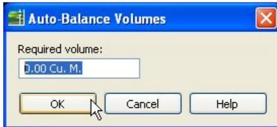
Si ingreso el valor cero, significa que el resultado del volumen será igual en corte y relleno, obteniendo un valor neto de cero. La figura siguiente muestra el resultado del cálculo.
